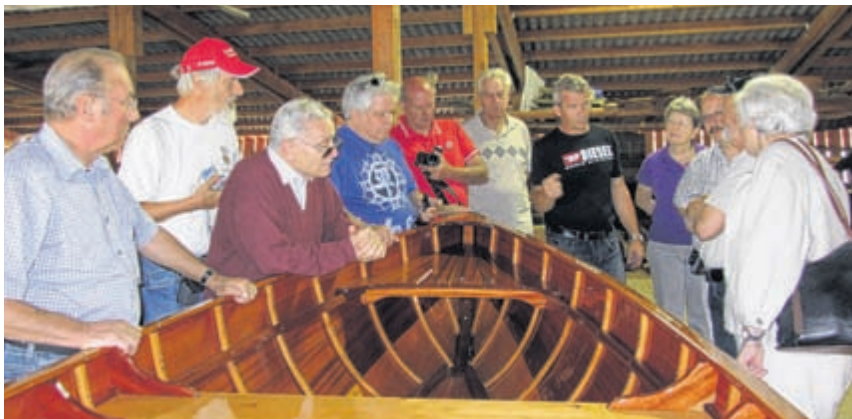
Rolf Hächler (im schwarzen T-Shirt) erklärt anhand des Schiffs Eleonora die Feinheiten der Klinkerbauweise.
