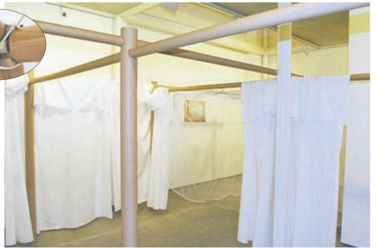
Der Architekturstudent Tatsunobu Ito von VAN vor der Notunterkunft im Hof des Kunstraums. Dank Röhren verschiedener Durchmesser braucht es für den Aufbau der Abtrennsysteme nicht einmal mehr Verbindungsstücke. Im Bildausschnitt das ältere System: Holz-Verbindungsstück im Inneren des Notzelts.
