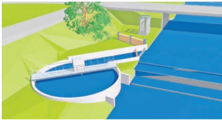
Projektstudie des geplanten Wasserwirbelkraftwerks.
