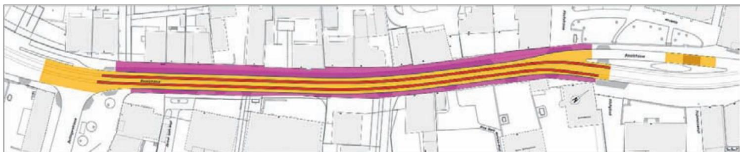
Die geplanten Sanierungsarbeiten bringen auch Veränderungen mit sich. Gut ersichtlich: Das Trottoir auf Seite Dorfkirche wird verbreitert, dafür aber abgesenkt (schraffierte Fläche), damit weiterhin parkiert werden kann. Die Traminsel (rechts) wird über einen Zebrastrassenstreifen mit dem Trottoir verbunden.
