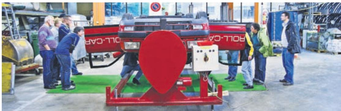
Der Höhepunkt der Übung: Der «Roll-Car» kann 360 Grad um die Längsachse gedreht werden.
