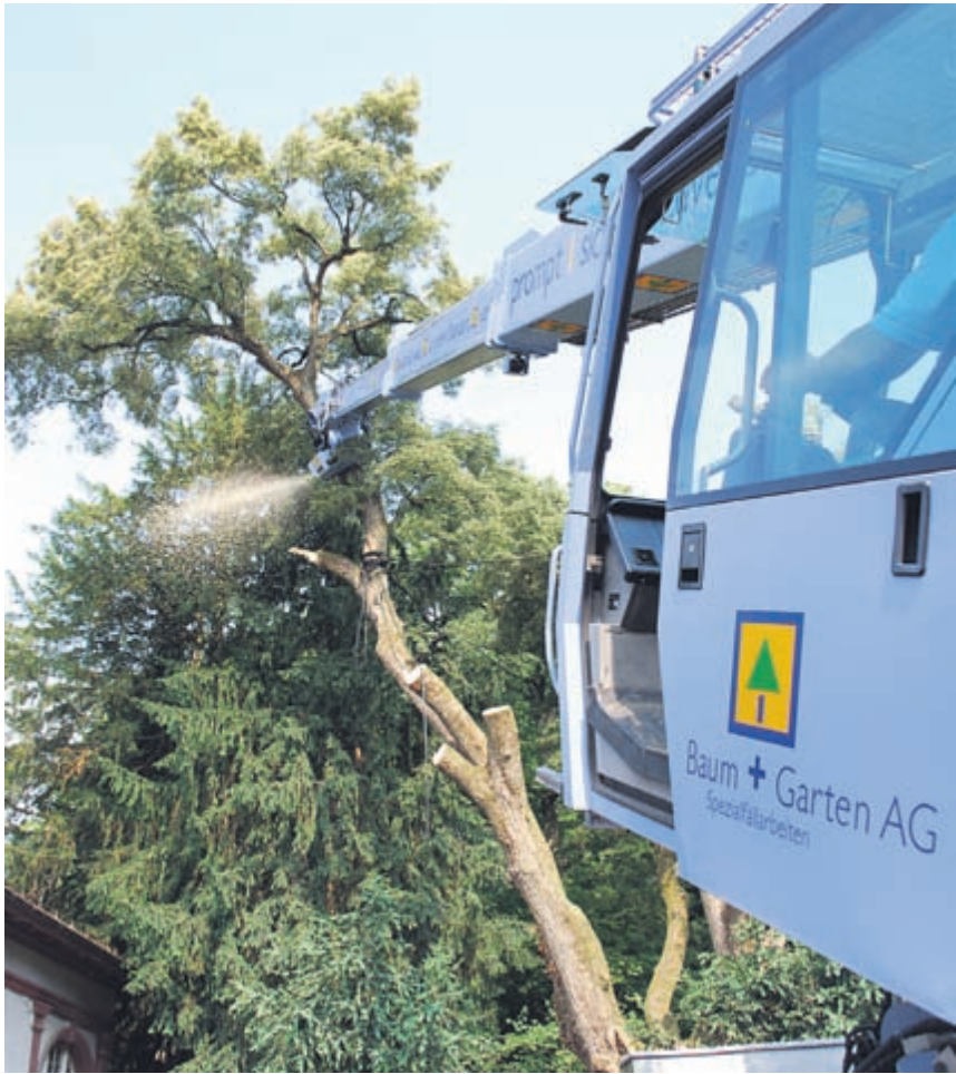
Der Kran greift, sägt ab, dreht sich um die Achse und übergibt an den zweiten Kran für den Transport.
