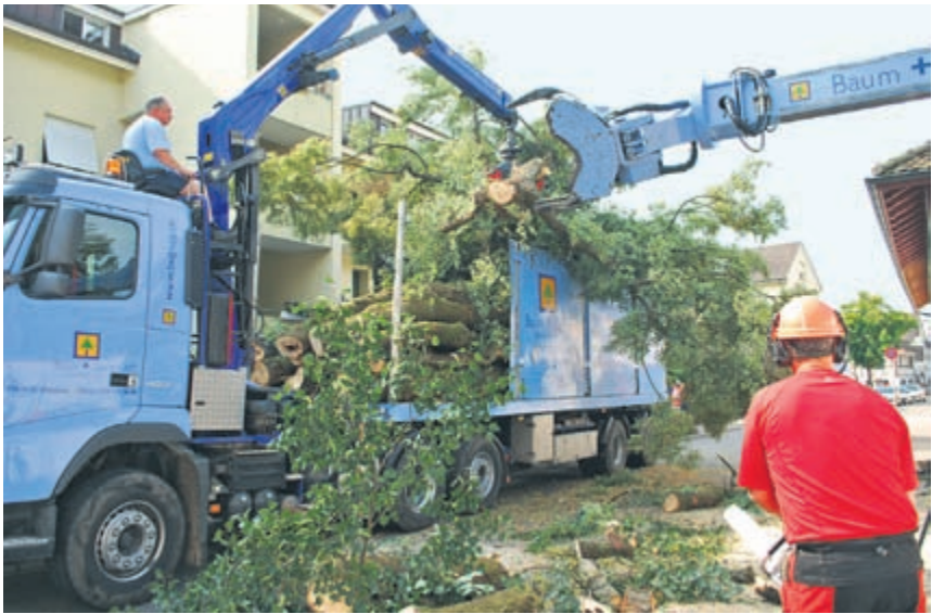
Der Kran greift, sägt ab, dreht sich um die Achse und übergibt an den zweiten Kran für den Transport.
