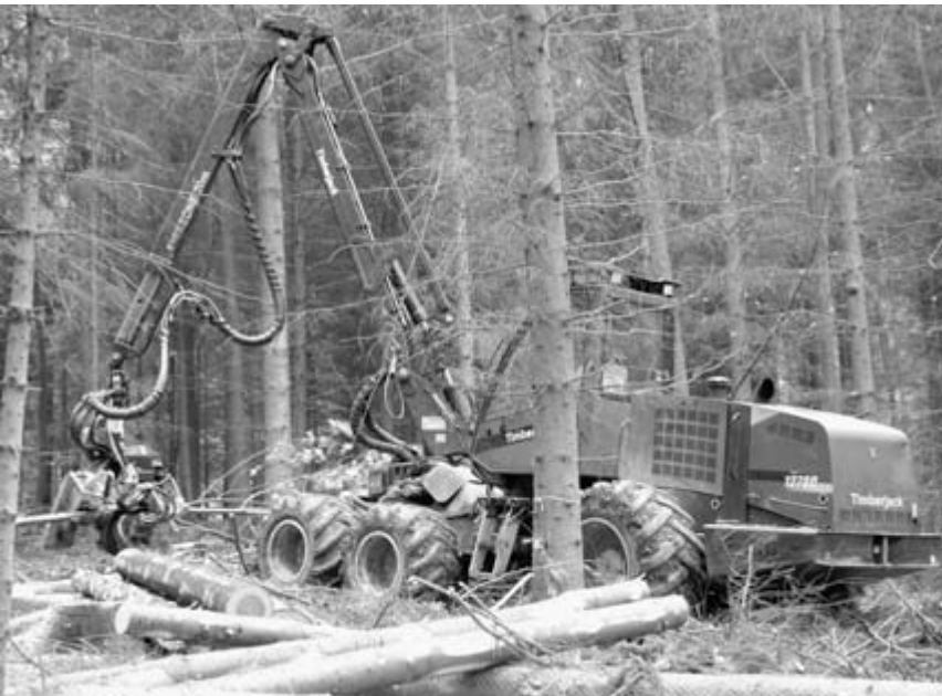
Der Vollernter im Einsatz – im Vordergrund die schon fertig gerüsteten Baumstämme, im Hintergrund der Greifarm mit einem Baum.
