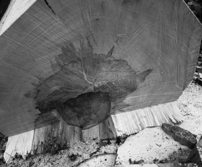
Alter Buchenstamm mit Rot- und überlagertem Spritzkern. Obwohl dieser astfreie, fast ohne Krümmung gewachsene Stamm äusserlich keine Mängel vermuten lässt, erzielen solche Stämme nur noch unterdurchschnittliche Preise.
