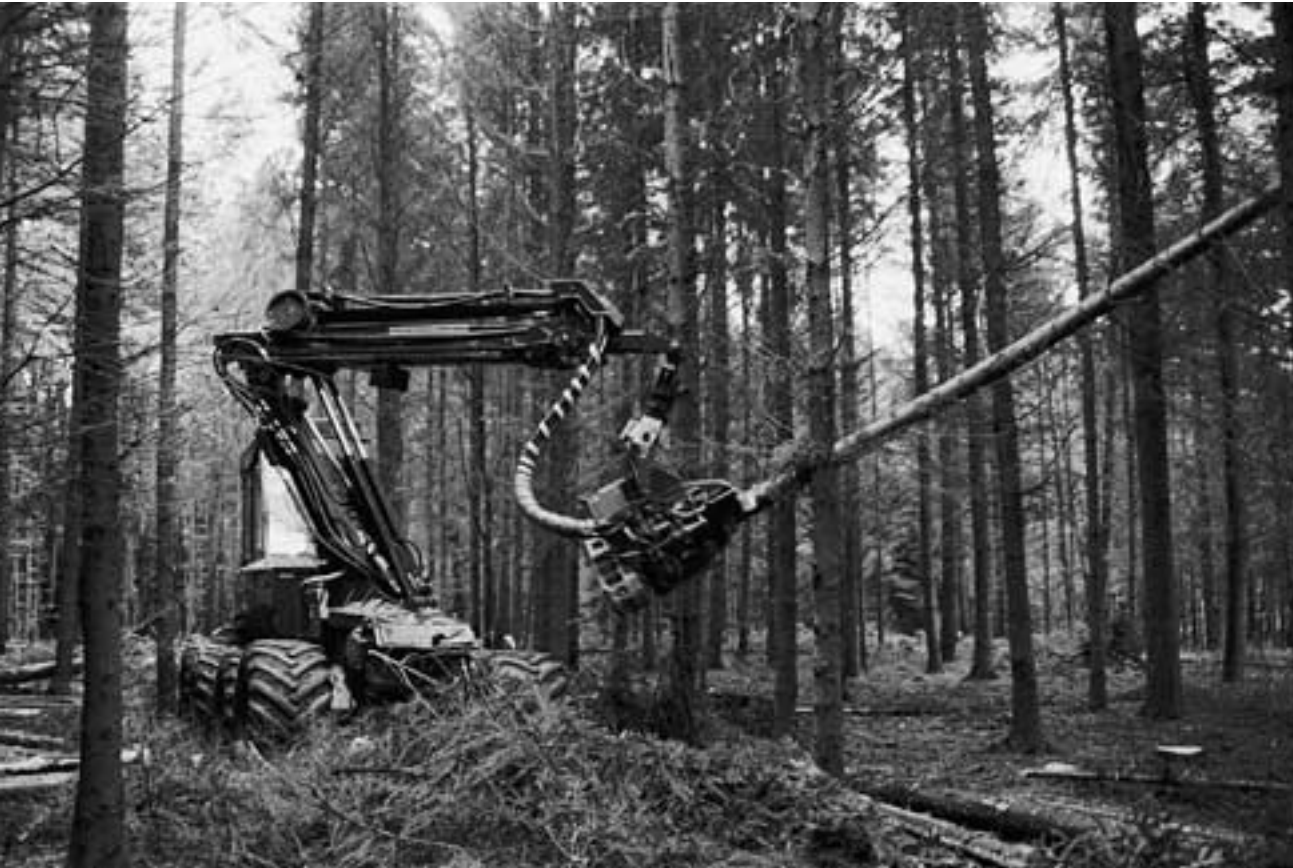
Demonstration im Wald: ein Vollernter, der Bäume packen, abschneiden, entästen und die Stämme auf die gewünschte Länge zuschneiden kann, im Einsatz.
