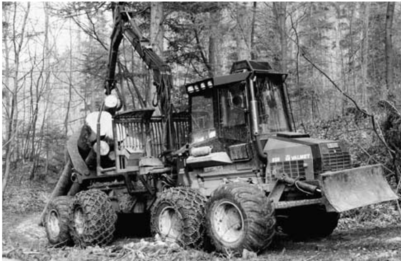
Ein Forwarder (Tragschlepper) mit Klemmbankrüstung beim Transport von Langholz aus dem Holzschlag an die Waldstrasse.
