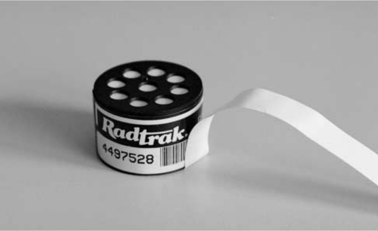
Mit solchen Dosimetern wird während drei Monaten die Radonkonzentration in Liegenschaften gemessen. Hausbesitzer können die filmspulengrossen Messgeräte zum Preis von 30 Franken kaufen.
