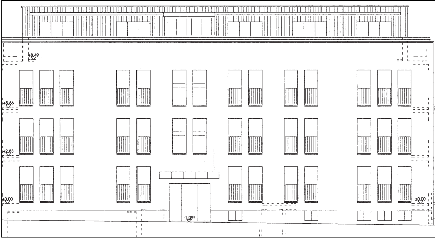
Die Vorderansicht des neuen dreistöckigen Mehrfamilienhauses ist charakterisiert durch eine ruhige Gliederung der Fenster sowie das zurückversetzte dritte Stockwerk mit einer Attika-Wohnung und einer grossen Dachterrasse. Plan: zVg
