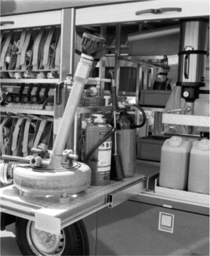
Neben den Schläuchen verfügt das neue Löschfahrzeug auch über einen schaumtauglichen Wasserwerfer (im Vordergrund) und einen weiteren Schaumaufsatz.
