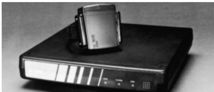
Das am Fuss zu tragende Alarmgerät (oben) sendet Impulse an ein an der Telefonsteckdose angeschlossenes Modem. Wenn die Trägerin oder der Träger die Wohnung entgegen der Vereinbarung verlässt, geht der Alarm los. Foto: zVg
