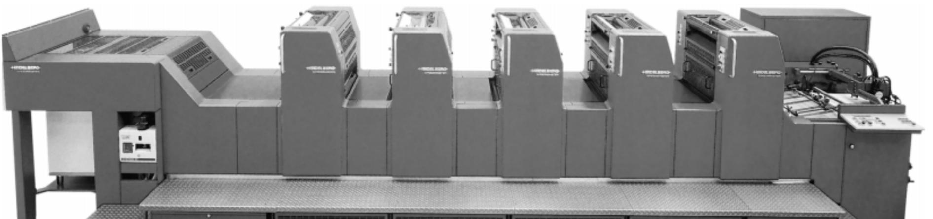
Der neue Schwerarbeiter, die 5-Farben-Offsetmaschine von Heidelberg, die bis 15'000 Bogen pro Stunde bedruckt.
