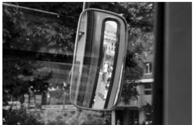
Aus der Tramperspektive: Der Pfeil zeigt, dass die folgende Weiche auf Abzweigung nach rechts gestellt ist, das Licht daneben, dass die Weiche von keinem Tram gestellt werden kann, bis man selbst passiert hat (Bild links). Das Signal in der Mitte zeigt vor einer Weiche «Rot» (Querbalken) für Linksabbieger und «Gelb» (Dreieck) für geradeaus. Mit dem Spiegel rechts lassen sich die Türen überwachen.
