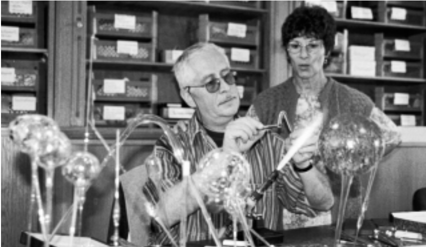
Flink dreht Peter Keil den in der Gasflamme erhitzten Glasstab um seine eigene Achse und biegt aus der Bewegung heraus Rundungen für ein Schmuckstück. Assistierend zur Seite steht seine Frau Edith Keil-Augenstein. Foto: Judith Fischer
