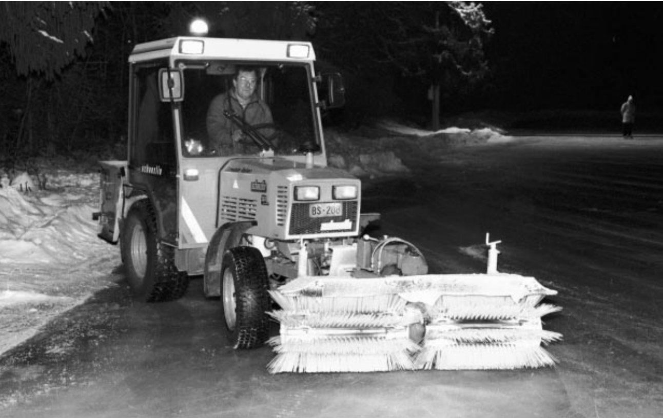
Mit einem grossen Bürstenaufsatz wird die Eisfläche am Abend gereinigt und von abgesplittertem Eis befreit, anschliessend wird das Eis mit einem Schlauch geschwemmt.
