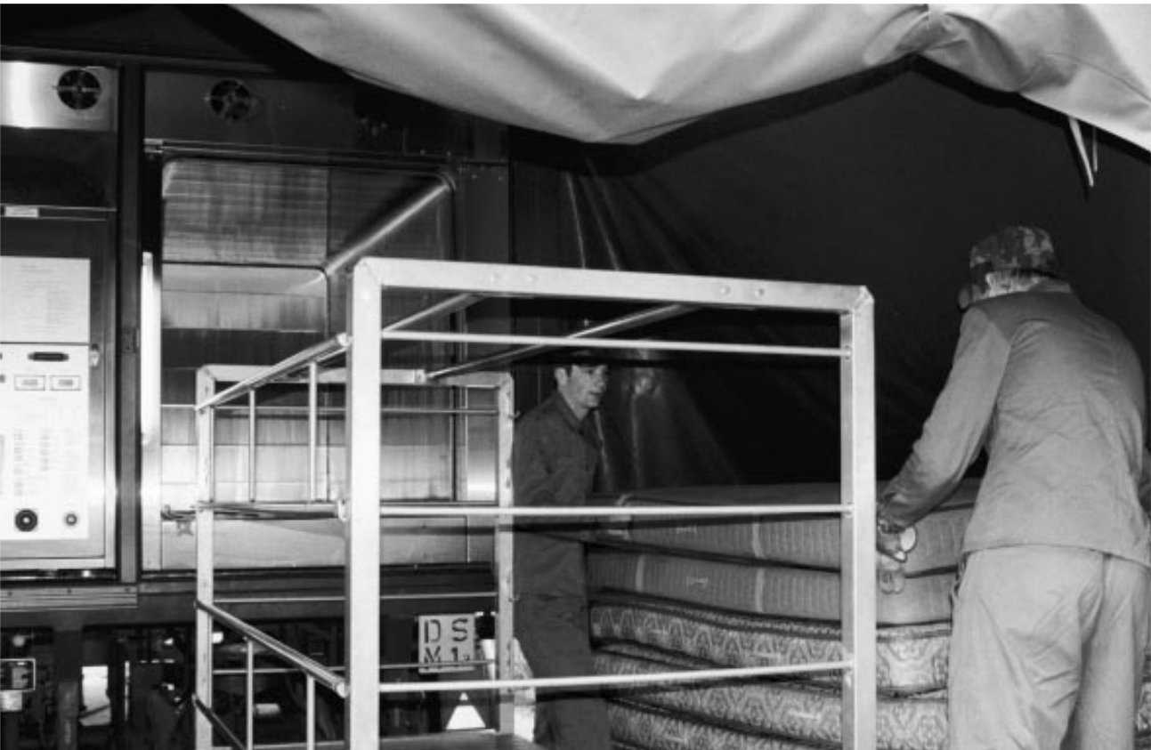
Zwei Rekruten des Hygienezuges hieven Matratzen auf das Transportgestell, von da werden sie in die Desinfektionskammer geschoben. Nach circa 80 Minuten ist die Ware desinfiziert und trocken.
