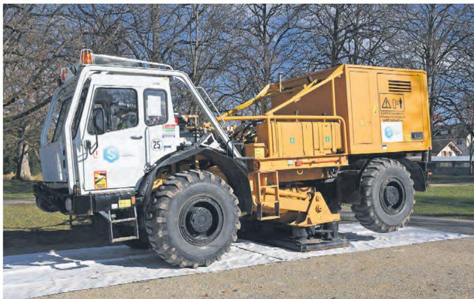
Ein Vibrotruck erzeugt im Sarasinpark zur Demonstration mit der auf den Boden gepressten Platte Vibrationen, die von den Messgeräten registriert werden können.
