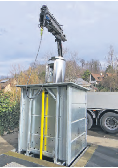
Hydraulisch wird der Kleidercontainer hochgefahren. Jetzt zur Kontrolle, später, um ihn zu leeren.
