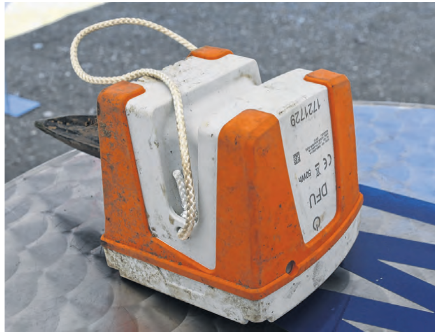
Ein Geofon am Erdwärme-Besuchstag im Sarasinpark – rund 9000 solcher Messgeräte waren im Einsatz und werden in diesen Tagen wieder eingesammelt. Foto: Rolf Spriessler
