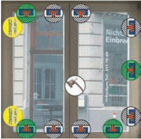
Verriegelung mit Pilzköpfen, minimale und optimale Anzahl.
