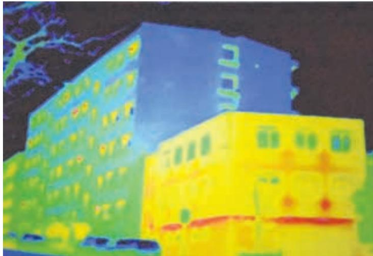
Die Aufnahme einer Wärmebildkamera zeigt die unterschiedliche Wärmeabstrahlung von verschiedenen Gebäuden – und damit den Wärmeverlust, den eine gute Isolation verhindern kann.
