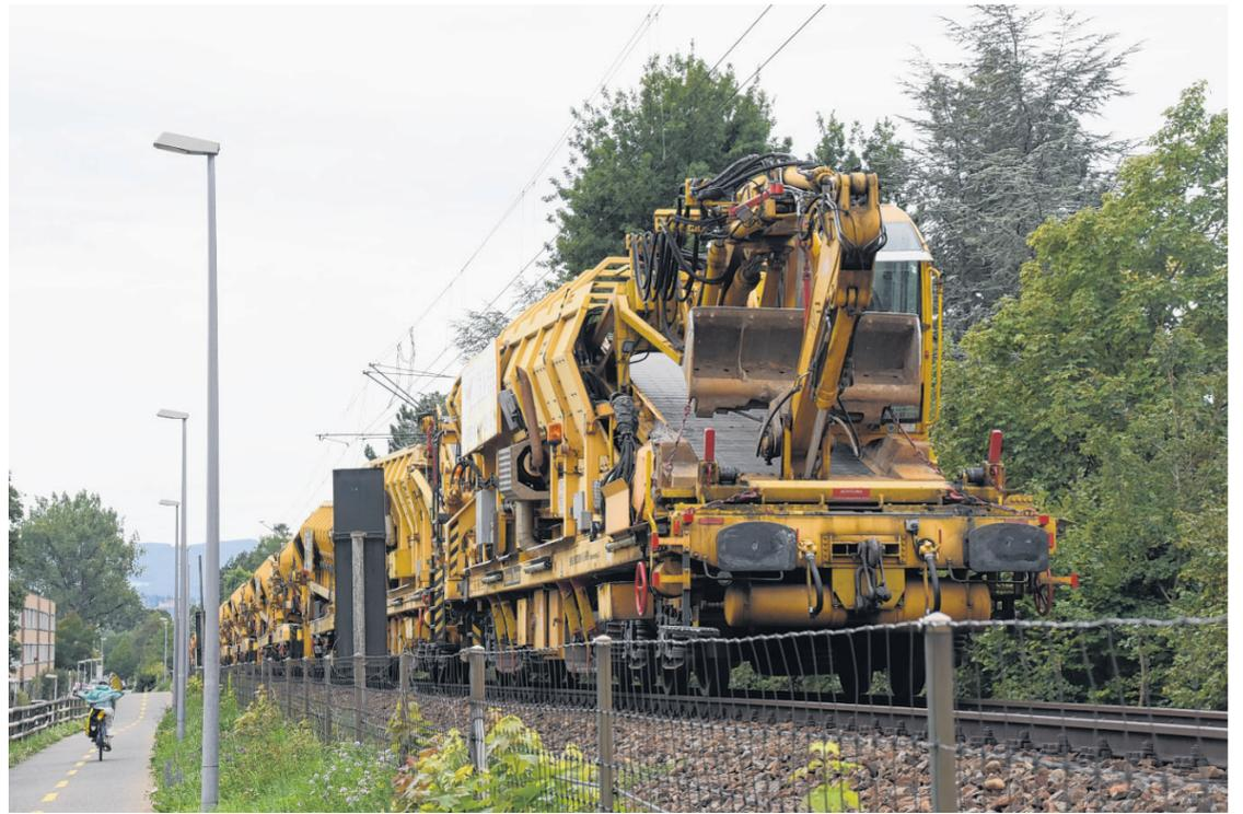
Dank des SUZW-500 erfolgt der Austausch von Schienen und Schwellen schnell und präzise.
