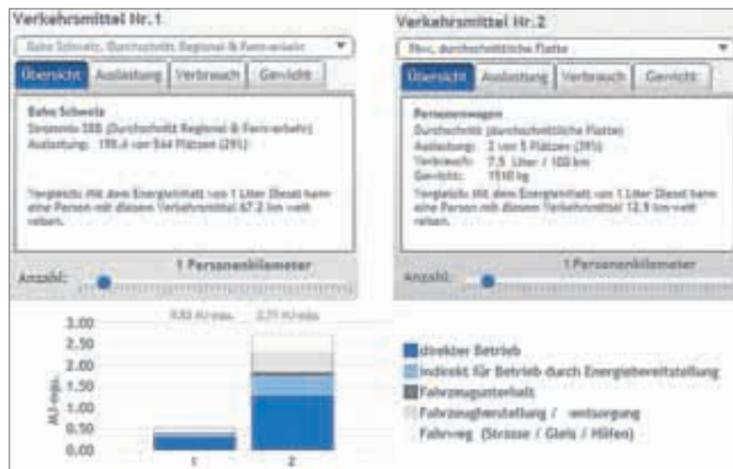
Vergleich Energieverbrauch pro Personenkilometer zwischen Bahn und PKW, erstellt mit dem Vergleichsrechner von www.mobitool.ch.
